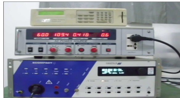
АЮ Измеритель импульсного воздействия ЭМИ источников питания, переключений, импульсных напряжений, переходных процессов, перепадов напряжения
